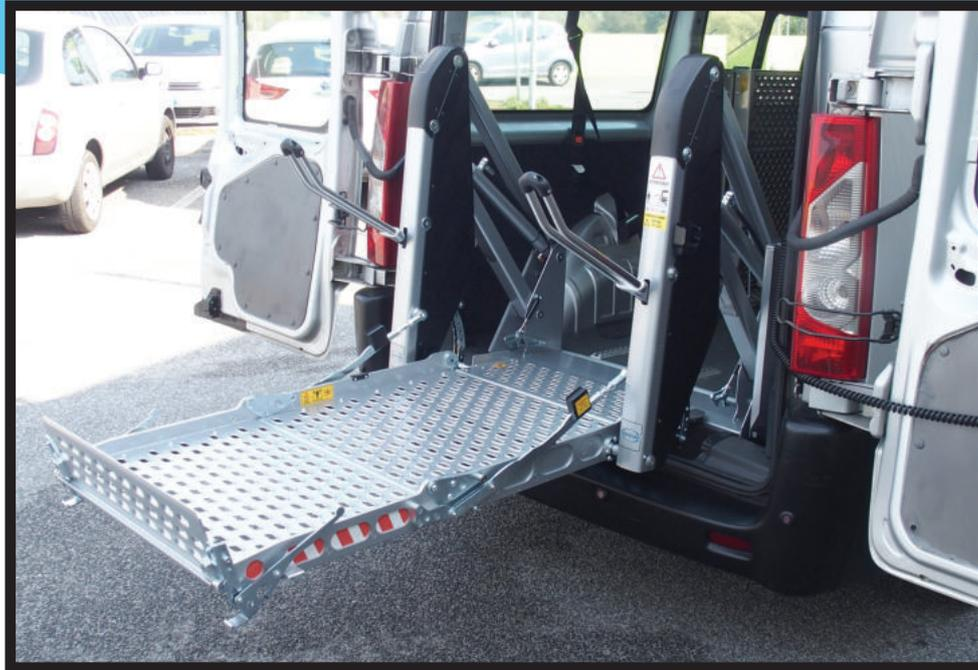
**Elevador electrohidráulico construido con un material robusto pero de peso reducido con doble brazo y plato plegable con movimiento automático.**
