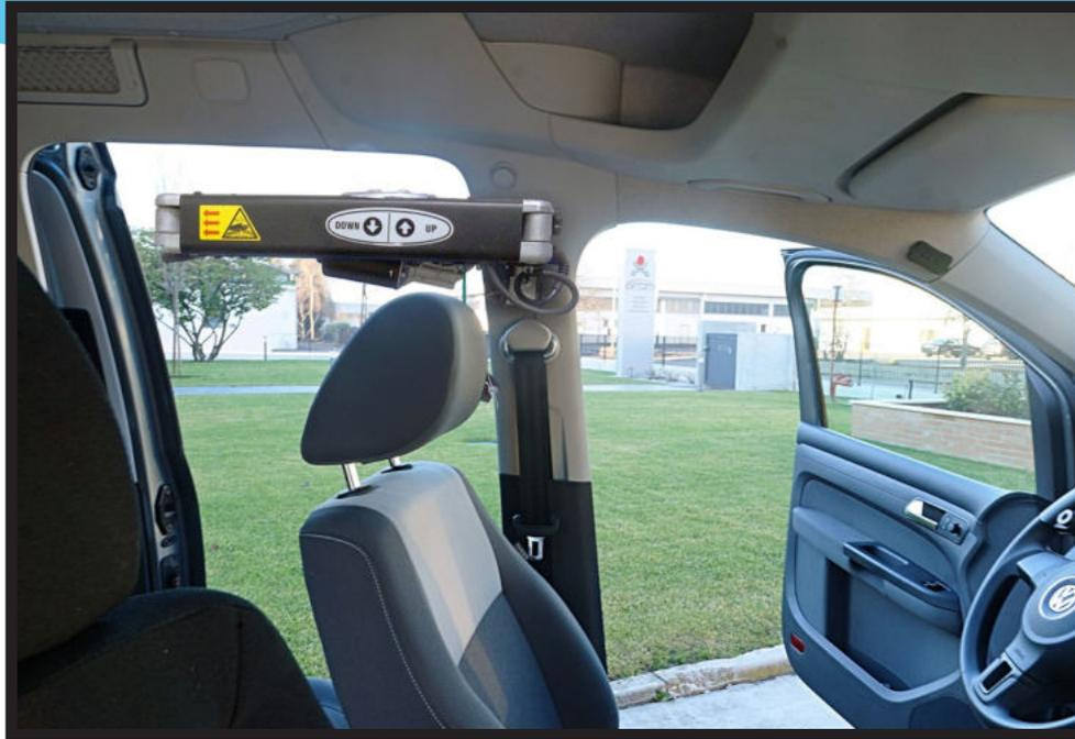
**Dispone de un brazo de carga articulable en 3 puntos que permite posicionar fácilmente la silla de ruedas en el interior del vehículo en la posición deseada.**
