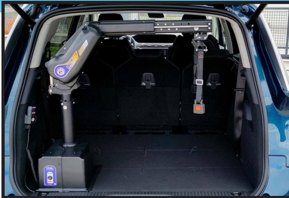
Permite levantar sillas de ruedas que se encuentran en posiciones alejadas del vehículo. Permite un ajuste en altura y en longitud durante la instalación.
