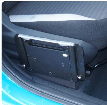
**SEG08** Con su pequeño tamaño permite la instalación en una amplia gama de automóviles sin tenerlo que extraer, ya que no molesta al cerrar la puerta y se puede instalar tanto en el lado del conductor como en el del pasajero. El usuario lo puede utilizar y guardar sin tener que extraerlo. Facilita el acceso y la salida del vehículo. Es eficiente, muy discreto y garantiza una transferencia segura.
