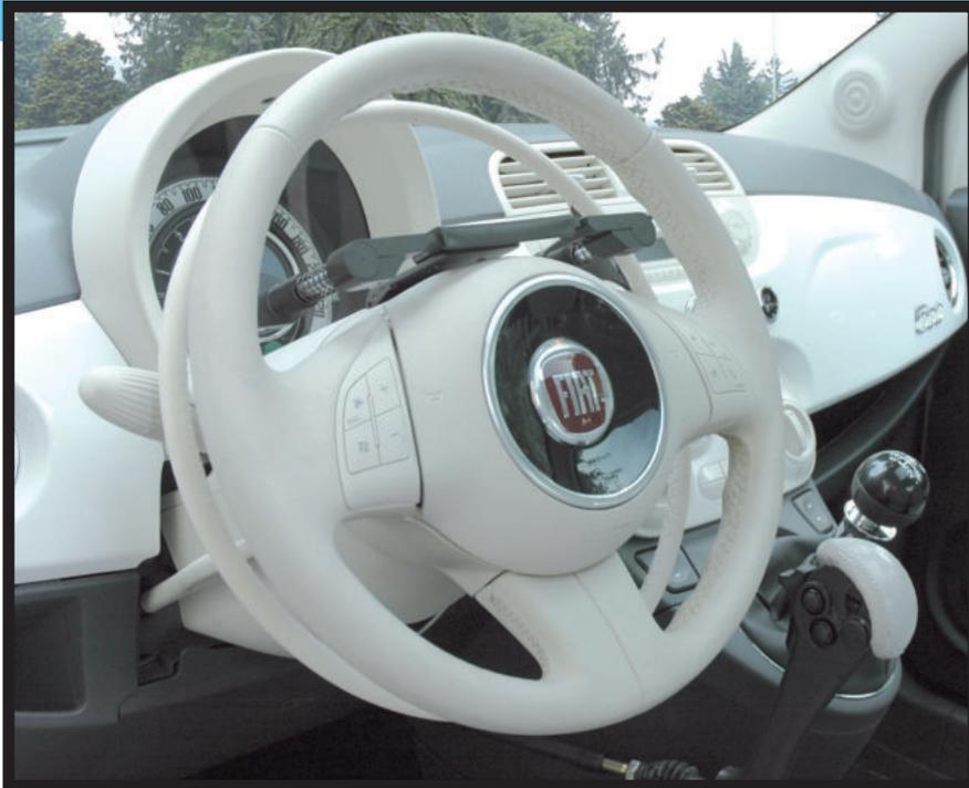
**Este acelerador nos permite acelerar presionando el aro hacia el volante sin abandonar el agarre de manera cómoda y segura.**
