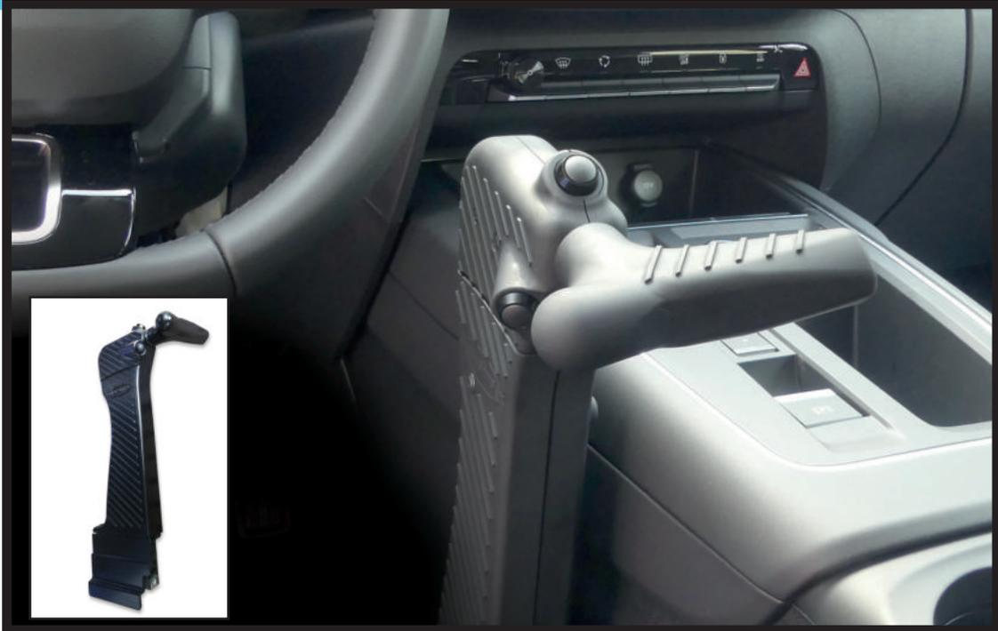
**Leva de freno al piso con acelerador electrónico de rotación.
